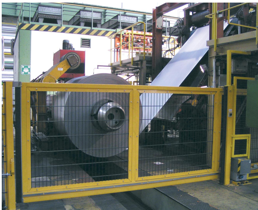
Bild 1. Über zwei Haspeln wird ein Stahlband von 1 km Länge in die Anlage transportiert
